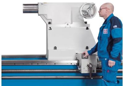
*Der Reitstock kann motorisch positioniert werden (alle Modelle ab 3000 mm Spitzentiefe)*
