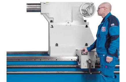
*Posicionamiento motorizado del cabezal (todos los modelos con un ancho central mínimo de 3000 mm)*
