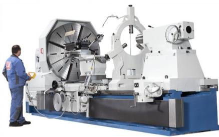
*Se incluye un control manual compacto del husillo principal para proporcionar un control total del proceso durante las operaciones de mecanizado complejas*
