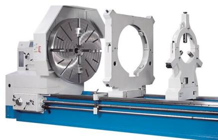
*Люнеты — необходимое оснащение для обработки длинных заготовок*
