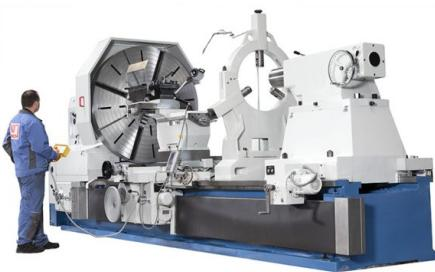
Für das Schalten der Hauptspindel steht dem Bediener zusätzlich ein kompaktes Handbediengerät zur Verfügung, um auch bei komplexen Bearbeitungen die volle Prozesskontrolle zu gewährleisten
