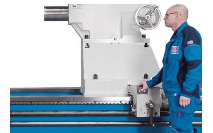
Der Reitstock kann motorisch positioniert werden (alle Modelle ab 3000 mm Spitzentiefe)
