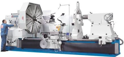
*Los engranajes de 21 pasos garantizan un par elevado en toda la gama de velocidades escalonadas de precisión a partir de 2 rpm.*
