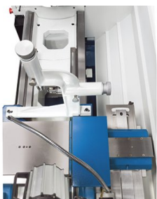
Ускоренный ход суппорта доступен в продольном и поперечном направлениях
