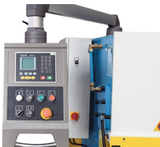
Commande CN pour un positionnement rapide de la butée arrière
