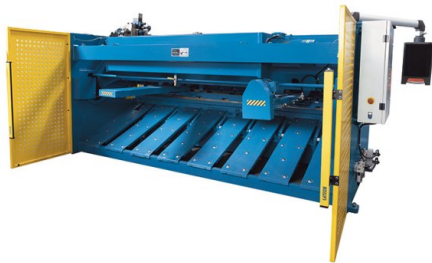
Con il supporto del prelamiera comandato dal controllo è possibile posizionare con precisione anche lamiere sottili sull'arresto posteriore
