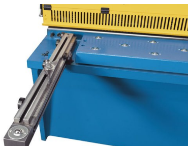
Łatwy w obsłudze ogranicznik kątowy z dźwignią zaciskową i skalą kątową
