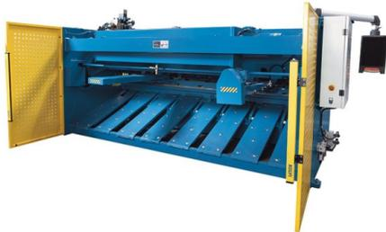
*Mit Hilfe der pneumatisch gesteuerten Blechhaltevorrichtung können auch dünne Blechtafeln exakt am Hinteranschlag positioniert werden*
