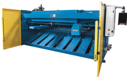
Устройство для крепления стального листа с пневматическим управлением позволяет даже точно позиционировать за заднем упоре даже тонкие листовые заготовки
