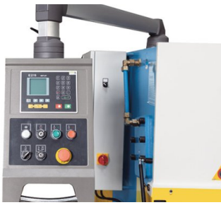
Система числового управления для быстрого позиционирования заднего упора
