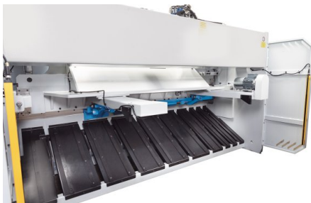
Pomocí volitelného, pneumaticky ovládaného přípravku na přidržování plechu lze i tenké plechy přesně umístit na zadní doraz
