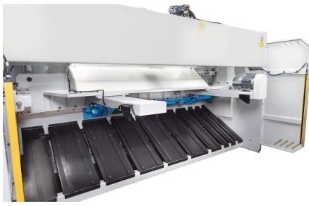
Grâce au dispositif de maintien en hauteur de la tôle à commande pneumatique en option, il est possible de positionner les tôles fines de manière précise sur la butée arrière
