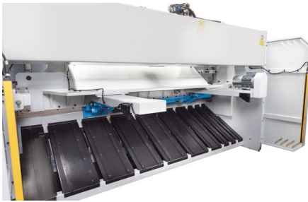
Mit Hilfe der optionalen pneumatisch gesteuerten Blechhochhaltevorrichtung können auch dünne Blechtafeln exakt am Hinteranschlag positioniert werden
