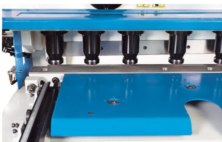
Supports de grande capacité pour un maintien efficace des panneaux
