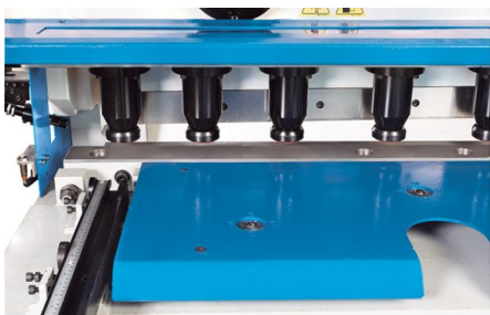
Držáky s velkou kapacitou pro pevné upnutí desek
