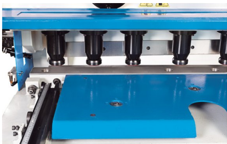
Uchwyty o dużej wytrzymałości, zapewniające dobre utrzymanie płyt
