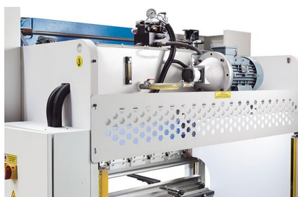
Le groupe hydraulique se trouve sur la partie haute de la machine et offre un espace de pliage supplémentaire
