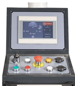
Commande intuitive avec grand écran tactile et trois modes de fonctionnement : manuel/semi-automatique/automatique
