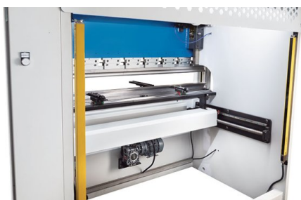
Partea posterioară este protejată cu perdele luminoase
