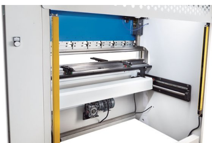
La partie arrière est protégée par des barrières immatérielles
