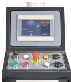
Intuitivní řízení s velkým dotykovým displejem a třemi provozními režimy: ruční/poloautomatický/automatický
