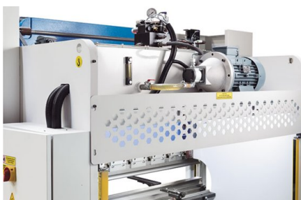
Hydraulická jednotka je umístěna v horní části stroje a poskytuje další prostor pro ohýbání
