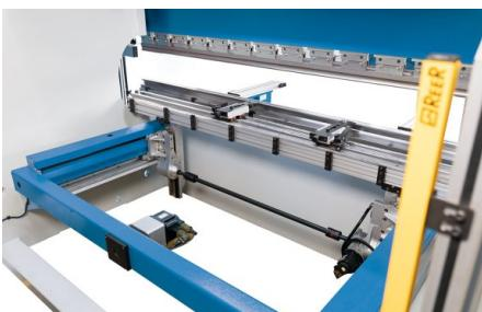
Optional: finecorsa posteriore con asse R controllato
