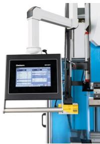
Il DA-53T rappresenta una soluzione completa di controllo touch all'avanguardia per le presse piegatrici sincronizzate. Offre una programmazione CNC estremamente semplice, basata sull'interfaccia grafica touchscreen di Delem.
