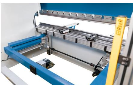
Optional: finecorsa posteriore con asse R controllato
