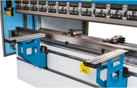
Die stabilen vorderen Auflagearme sind über einen Rastenmechanismus schnell in der richtigen Höhe einstellbar
