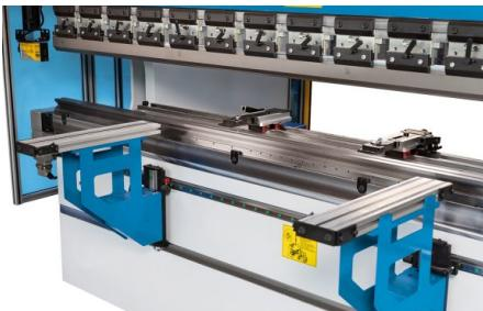
*Un mécanisme de verrouillage permet de placer rapidement les bras supports avant stables à la hauteur adaptée*
