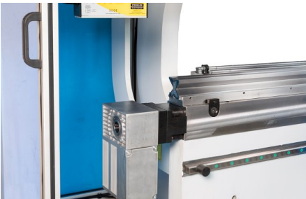
Die Motorische Tischbombierung gehört zur Serienausstattung der Maschine (optional für AHK V 13040)
