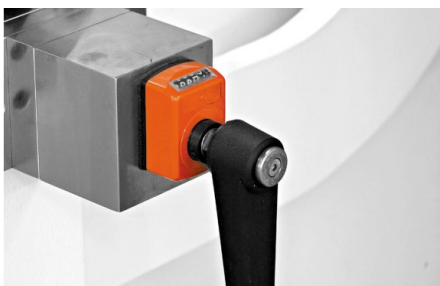
Toutes les machines sont équipées d'un système de bombage intégré dans la table. Une version motorisée du bombage est disponible en option.
