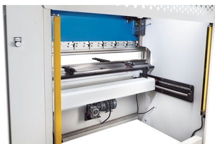
La parte trasera está protegida con cortinas de luz
