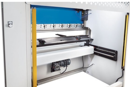
Die Rückseite ist durch Lichtvorhänge geschützt
