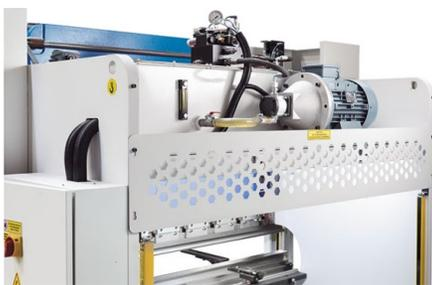
*Il gruppo idraulico si trova nella parte superiore della macchina ed offre spazio di piegatura aggiuntivo*
