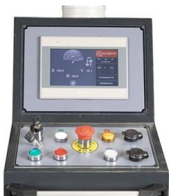
*Controllo intuitivo con ampio touchscreen e tre modalità operative: manuale/semi-automatica/automatica*
