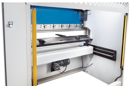
Задняя сторона защищена световой завесой
