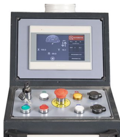
Unitate de comandă intuitivă cu ecran tactil mare și trei moduri de operare: manual/semiautomat/automat
