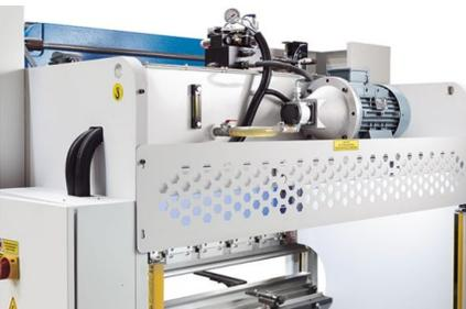
La unidad hidráulica está situada en la parte superior de la máquina, lo que proporciona espacio adicional para el curvado
