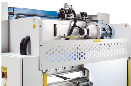
Das Hydraulikaggregat befindet sich oben auf der Maschine und bietet zusätzlichen Biegebaum
