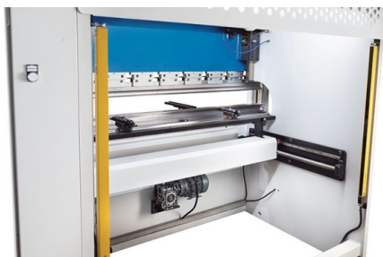
Die Rückseite ist durch Lichtvorhänge geschützt
