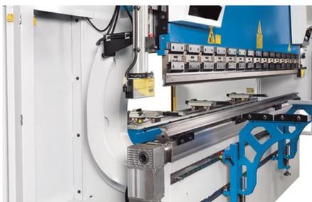
La bombatura motorizzata opzionale consente all'operatore di compensare più rapidamente le deviazioni nel pezzo durante il processo di piegatura.
