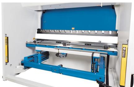
Le macchine di questa serie possono essere equipaggiate con un sistema opzionale di arresto posteriore con asse R.
