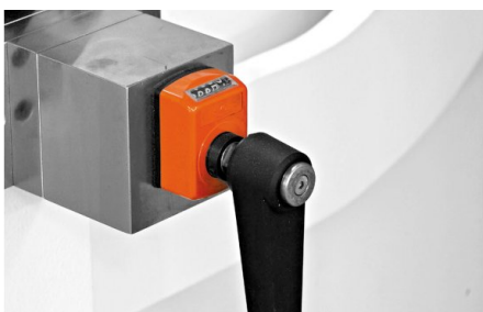
Alle Maschinen sind mit einem manuellen Bombiersystem innerhalb des Tisches ausgestattet. Eine motorisierte Bombierung ist als Option erhältlich.
