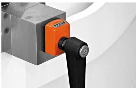
Tutte le macchine sono dotate di sistema di bombatura manuale nella tavola. Un sistema di bombatura motorizzata è disponibile come optional.
