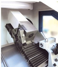
4-позиционный инструментальный револьвер и задняя бабка
