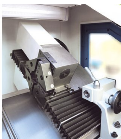
4-krotny rewolwer narzędziowy i konik
