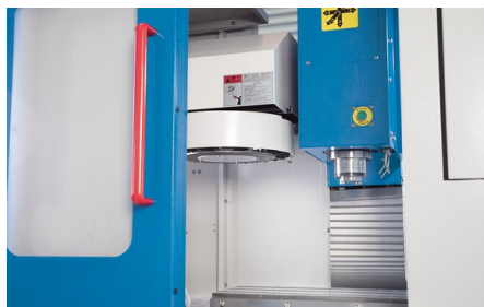
12-krotna zmieniarza narzędzi zapewnia produktywność i elastyczność
