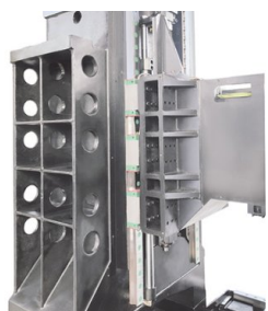
Corps en fonte avec une travée de grande dimension
