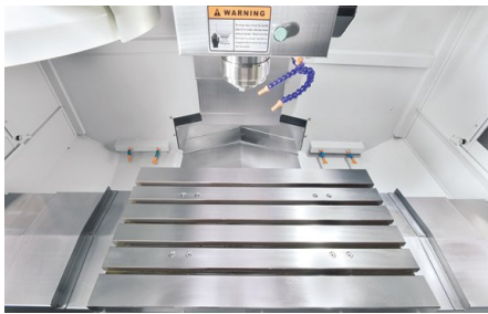
Mesa de máquina sólida con 5 ranuras
