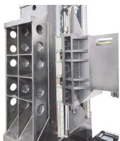
Corp din fontă cu deschidere mare a fălcilor
