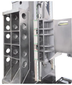
Gusskörper mit großer Spannweite
