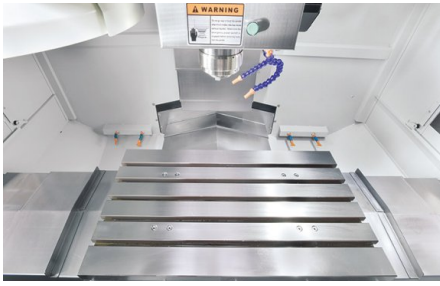
Massiver Maschinentisch mit 5 Nuten
