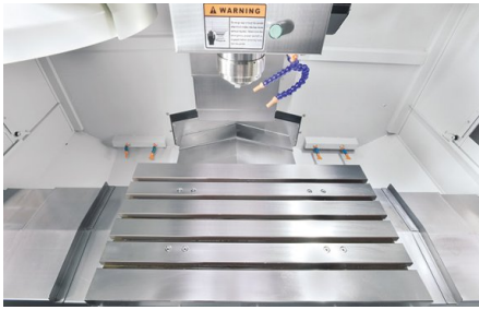
Massiver Maschinentisch mit 5 Nuten
