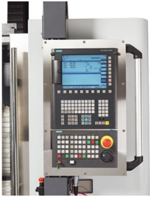
Система ЧПУ Siemens Sinumerik 828D с ПО ShopMill
