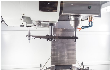
Schimbător de scule cu braț dublu și arbore BT 40
