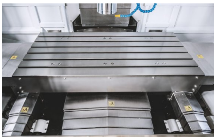
Guidages supplémentaires pour une capacité de charge supérieure et une plus grande stabilité
