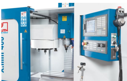
Базовые возможности фрезерной обработки с ЧПУ для серийного производства и обучения
