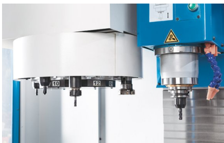
Узел смены инструмента (12 гнезд)
